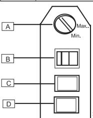
A تحكم درجة الحراره (جهاز تحكم درجة الحرارة)
